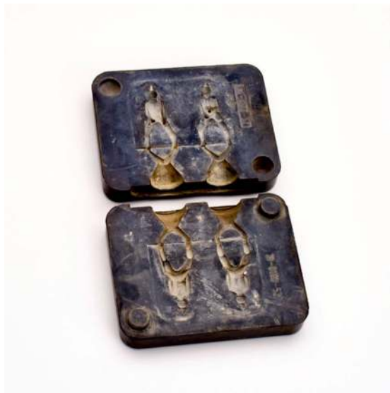
Abb. 14: Gießform aus Kautschuk der Spielwarenfirma Schildkröt, 9,8 x 7,8 x 3 cm (geschlossen), 1979. Foto: Achim Küst.
