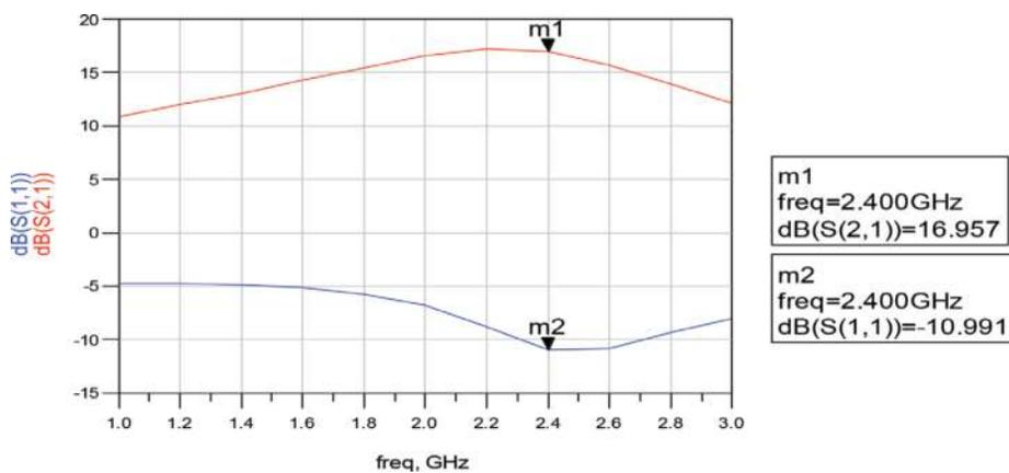
**Figure 14.** S-parameters of SDC LNA.
