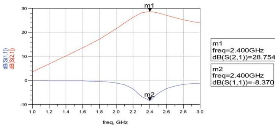
**Figure 15.** S-parameters of DDC LNA.
