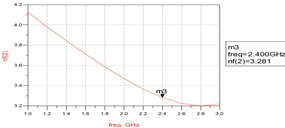
Figure 16. NF of SDC LNA.
