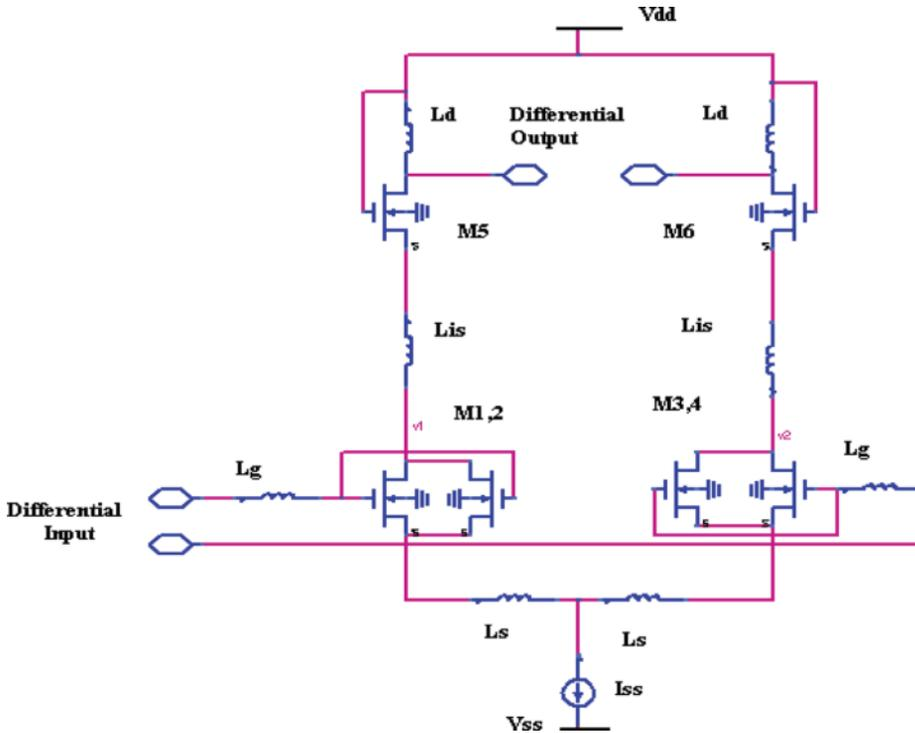
Figure 11. Schematic of DDC LNA.
