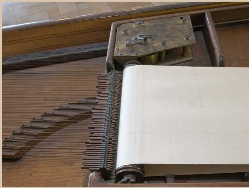
Notenschreibeeinrichtung an Merlins Cembalo mit Hammerflügel-Register (Deutsches Museum München)
