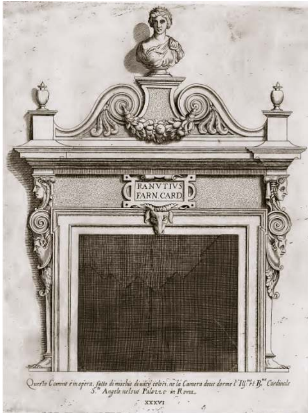
Jacopo Barozzi da Vignola, Regola delli cinque ordini d'architettura , Roma, presso l'Autore, 1562, tav. XXXVI; prospetto del camino nella stanza del cardinale Sant'Angelo (Ranuccio Farnese) in palazzo Farnese in Roma
