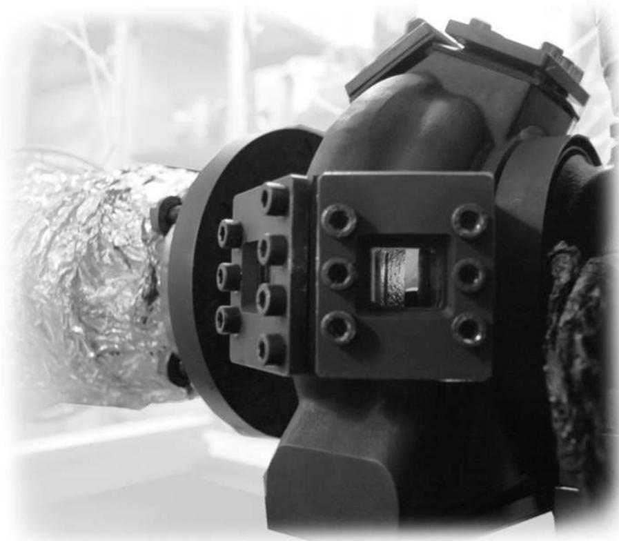
Bild 5.33: Turbinengehäuse mit optischen Zugängen zur Strömungsfelduntersuchung
